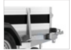
40 cm hohe Bordwände für mehr Volumen
